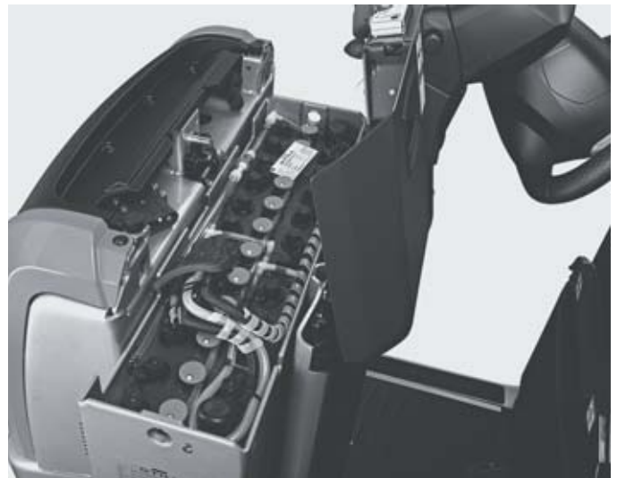
Remplacement optimal de la batterie par sortie latérale, pour une disponibilité maximale et une ergonomie inégalable pour l'opérateur
