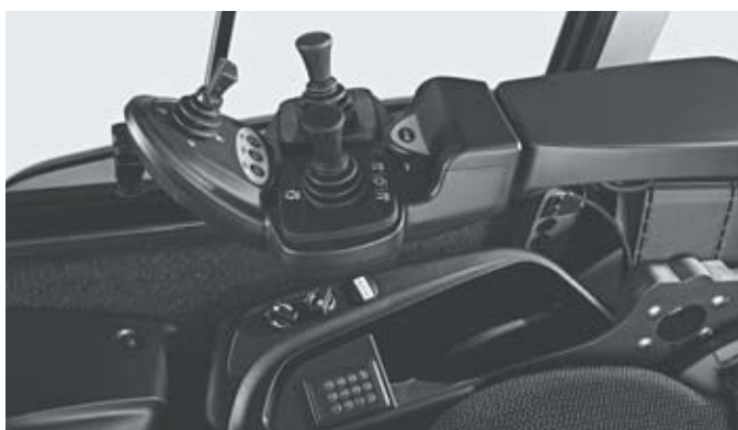
Commandes hydrauliques fluides et précises avec différentes options de commandes
