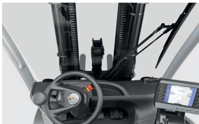
Contrôle visuel optimal des pointes de fourche
