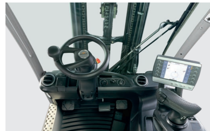
Poste de travail avec organes d'affichage et de commande, Joystick 4Plus et chauffage
