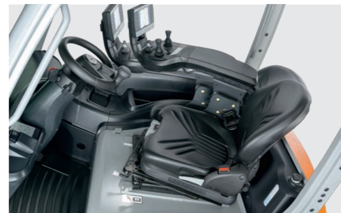
Siège pivotant pour une marche arrière plus pratique
