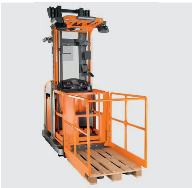
Plateforme avec accès palette avec clôture pour une préparation de commandes ergonomique avec des marchandises lourdes et encombrantes
