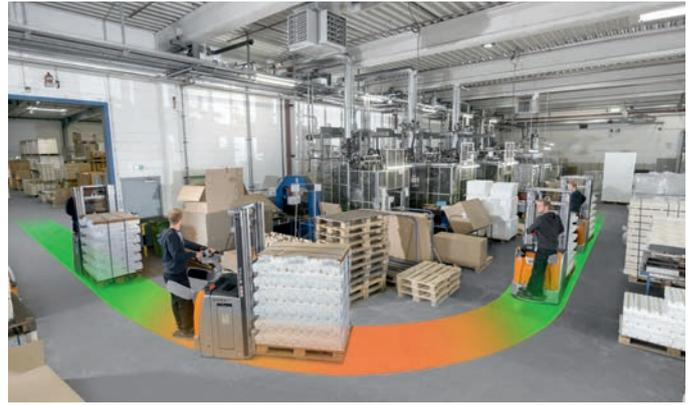
La sécurité même dans les virages : réduction automatique de la vitesse dans les virages
