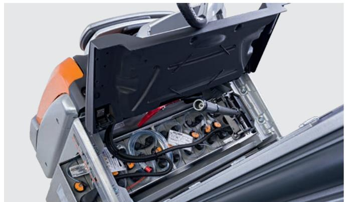
Rapidement et en toute sécurité : Le verrouillage innovant de la batterie permet un changement rapide de la batterie sans risque de coincement
