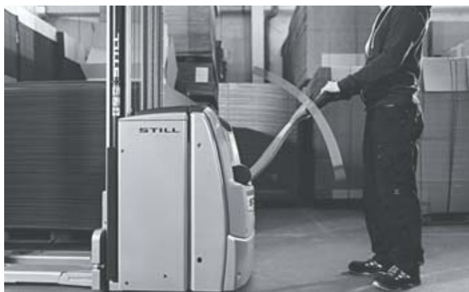
La sécurité de série : en fonction de la distance séparant l'opérateur du chariot, la vitesse s'adapte automatiquement à l'angle du timon
