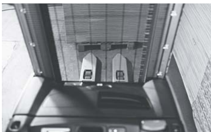
Visibilité toujours optimale sur les pointes des fourches grâce au cadre de mât STILL à visibilité dégagée
