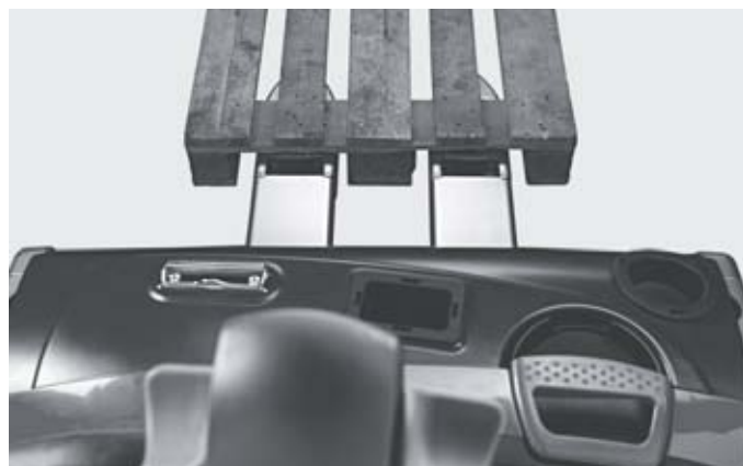
Contrôle visuel des pointes de fourches
